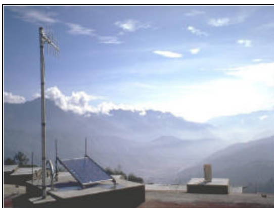
Figura 5.4 Pluviómetro, celda solar y antena de radio, estación Las Cruces, CR-02
