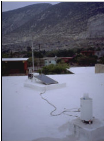
Figura 7.2 Pluviómetro, celda solar y antena de radio instalados en la azotea de la estación San Martín, SM-01
