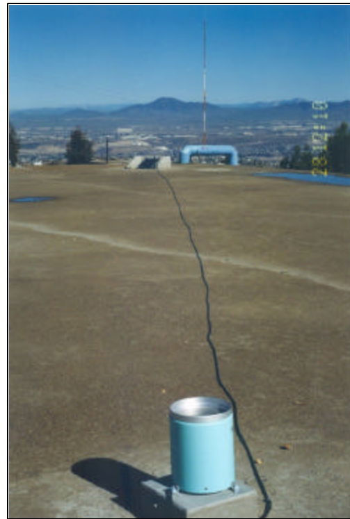
Figura 4.13 Pluviómetro y celda solar. Estación Sánchez Taboada
