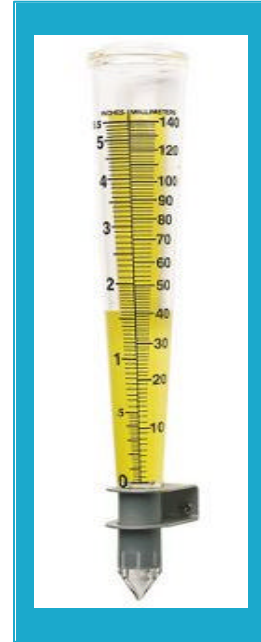
Figura 10. Aparato de bajo costo para medir la lluvia.
